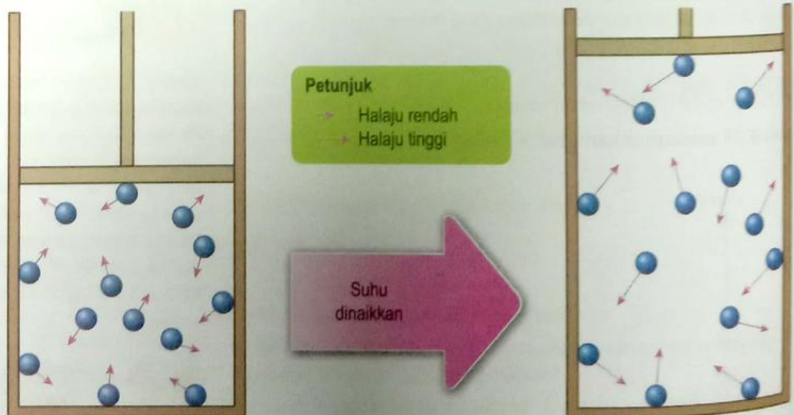
Rajah 4.30 Suatu gas berjisim tetap dipanaskan pada tekanan malar
