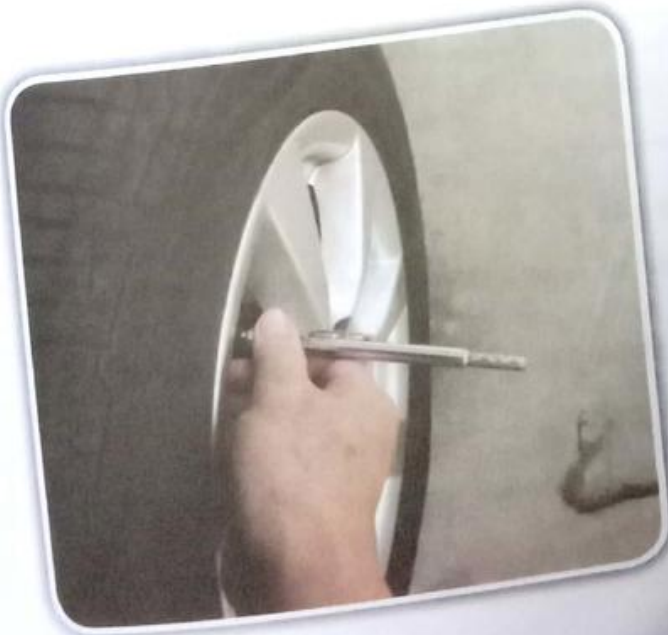
Gambar foto 4.6 Tekanan udara tayar kereta diukur
