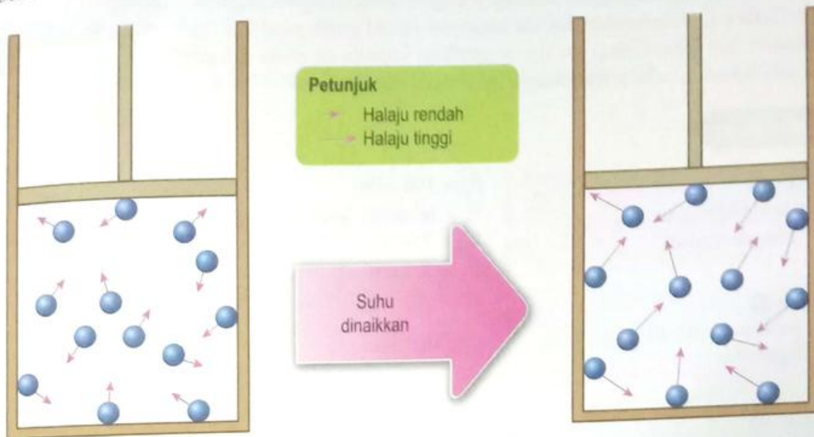
Rajah 4.34 Suatu gas berjisim tetap dipanaskan pada isi padu malar
