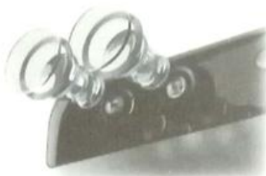
Gambar foto 6.6 Kanta dalam kamera telefon pintar
