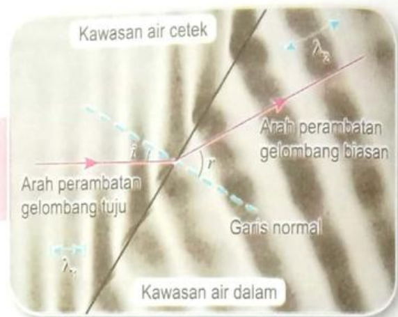
Rajah 5.36 Pembiasan gelombang air satah
